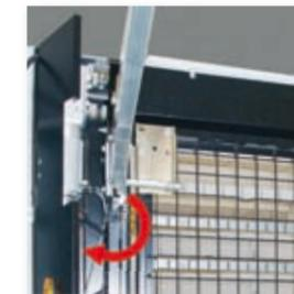
Pour faciliter les opérations de maintenance, moteur, platine électronique et sécurités sont accessibles par une porte verrouillée ouvrant sur toute la hauteur de la pile. Tout le câblage électrique est repéré par codification et une prise de courant est disponible sur la platine.
